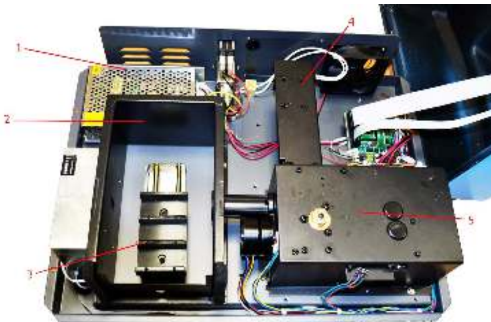
Рисунок 30 - Внутренняя платформа. Обозначения: 1 - радиатор; 2 - кюветное отделение; 3 - кюветодержатель; 4 - крышка лампы; 5 -отсек монохроматора.
